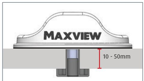
2. Die Antenne der Roam X wurde derart konzipiert, dass sie direkt auf einer waagerechten, flachen und glatten Oberfläche wie GFK (glasfaserverstärkter Kunststoff) montiert werden kann. Dabei werden die Koaxialkabel direkt unter dem Mittelpunkt der Antenne durch das Dach geführt. Das mitgelieferte Montagezubehör eignet sich für eine Dachdicke von 10 - 50 mm.
