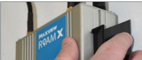
5. Platzieren Sie den Router in der Montagehalterung. Der Router kann jederzeit aus der Halterung genommen werden, wenn Sie die SIM-Karte wechseln müssen.
