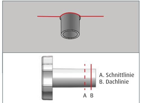
4. Entfernen Sie die Hohlschraube und schneiden Sie ihren Schaft auf die passende Länge zu. Die richtige Länge für die Montage ist die Dachdicke minus 3 mm. Dadurch wird sichergestellt, dass es an der Antenne zu keiner Stauchung kommt, wenn die Schelle festgezogen wird.
