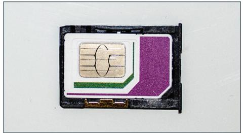
3. Öffnen Sie das SIM-Fach und legen Sie die SIM-Karte in Standard- oder Mini-SIM-Ausführung, flach mit der Chipseite nach oben ein. Schieben Sie den SIM-Karten-Schlitten in den Router bis er einrastet.
