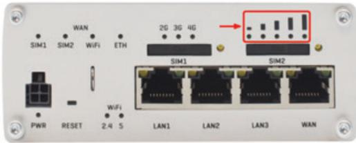
Die Anzahl der leuchtenden LEDs repräsentiert einen anderen Wert für die Mobilfunksignalstärke (RSSI) in dBm.
