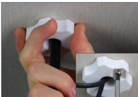
8. Befestigen Sie die Hohlschraube vom Fahrzeuginneren aus und ziehen Sie sie gegen den Uhrzeigersinn am Schraubgewinde fest, das aus der Unterseite der Antenne hervorragt. Drehen Sie so lange, bis die Hohlschraube das Montepad unter der Antenne zusammenpresst.
