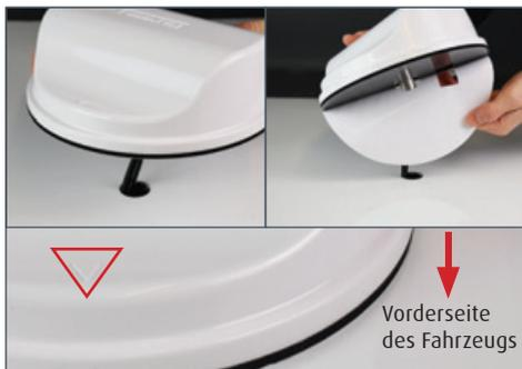
6. Führen Sie die Kabel durch die Öffnung und entfernen Sie die selbstklebende Rückseite des 3M-Montepads. Führen Sie die Kabel durch die Dachöffnung und richten Sie die Antenne so aus, dass der aufgeprägte Pfeil zur Vorderseite des Fahrzeugs zeigt. Die Außenränder der Antenne müssen dabei an der vorher angebrachten Markierung ausgerichtet werden.
