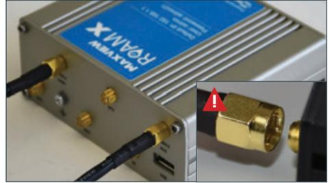
2. Schließen Sie die Koaxialkabel der Antenne an den zwei unteren Anschlüssen an. Sie sind mit dem Wort „mobile“ beschriftet. Die Anordnung der Kabel ist beliebig.
