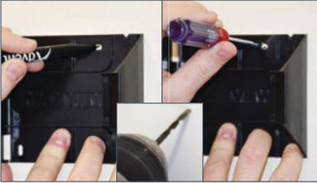
1. Platzieren Sie die Halterung des Routers und markieren Sie die Position der Bohrungen. Je nach Material können Sie entweder ein Führungsloch bohren oder eine Ahle verwenden. Befestigen Sie die Haltevorrichtung des Routers mit den beiden mitgelieferten Schrauben Nr. 6 an der Oberfläche.
