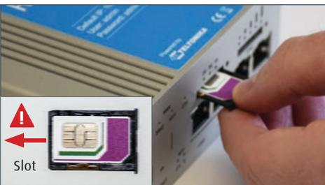
4. Schieben Sie das SIM-Fach mit der Karte wieder in den Router. Die Aufschrift an der Stirnseite des Fachs darf nicht auf den Kopf stehen. Schieben Sie das Fach in den Router bis es einrastet.
