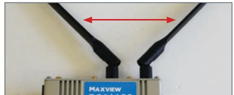
Die optimale Positionierung für die WLAN-Antennen an dem Roam X Router ist senkrecht nach oben. Die Antenne am Router können jedoch auch so montiert werden wie auf dem Bild oben gezeigt im 45°- oder 90°-Winkel oder nach unten oder vorne zeigend.
