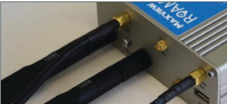
3. Bringen Sie die Wi-Fi-Antennen an den oberen Anschlüssen an. Diese sind mit „WLAN“ gekennzeichnet. Diese sollten so positioniert werden, dass sie senkrecht nach oben stehen.
