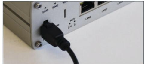
4. Schließen Sie den 12V-Anschluss oder das 230 V Netzteil (optional) an und verbinden Sie das Kabel mit Ihrer Stromquelle.
